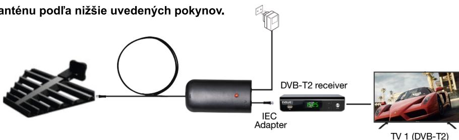
Poznámka: Po dokončení montáže a inštalácie antény nastavte anténu do najlepšej polohy na dosiahnutie jasného televízneho obrazu a potom zaistite anténu a upevnite koaxiálny kábel.
